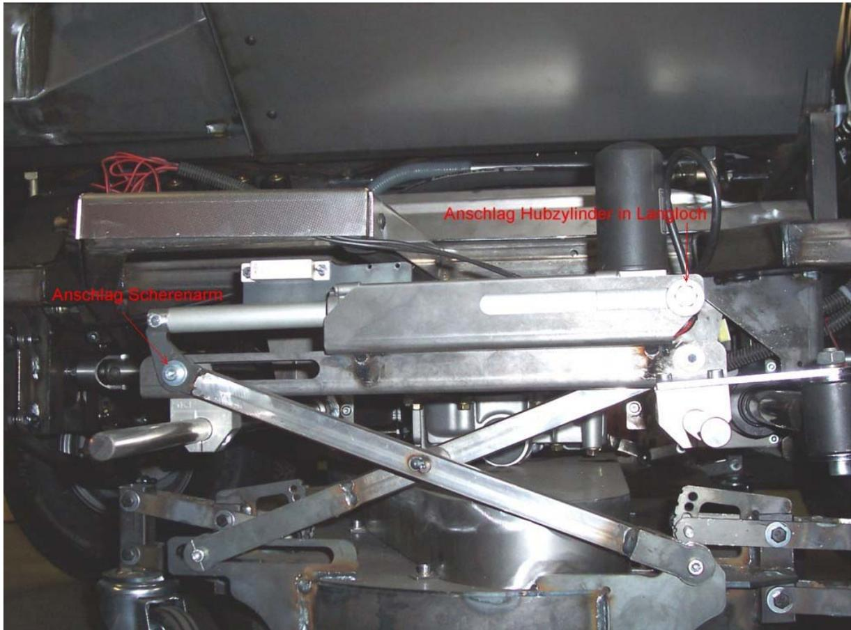
Das Absenken funktioniert logischerweise in umgekehrter Reihenfolge. Der Hubzylinder wird dabei in seiner kurzen Länge so eingestellt, das er mit seinen Befestigungspunkten ungefähr mittig in den Langlöchern steht.
