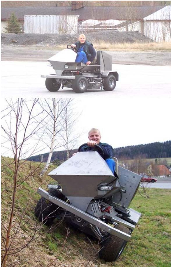
Die entwickelten Basiskomponenten „Dynamische Schwerpunktverlagerung“ und „transversale Verschiebbarkeit des Mähwerkes“ können mit Sicherheit auf andere Fahrzeuge adaptiert werden, wobei die Adaptierung der Mähwerkskonstruktion sicherlich leichter möglich ist.
